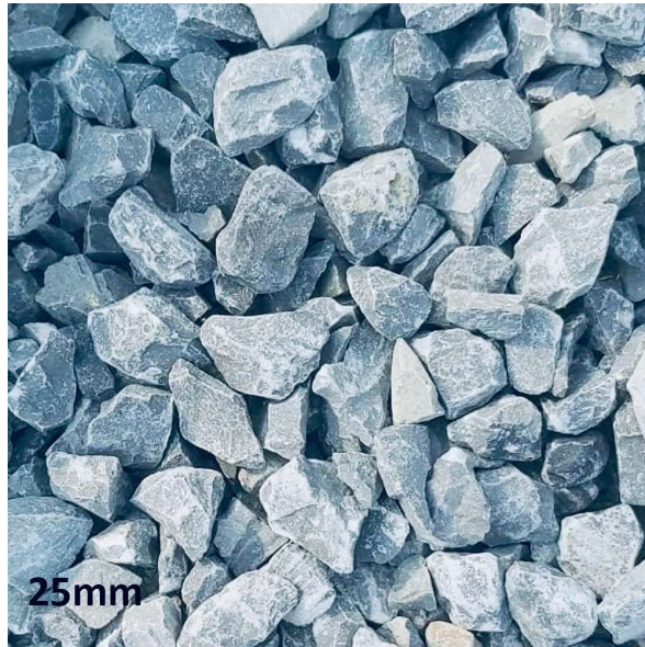
Fig 37.4.1-1.5-3 : 25 mm Concrete chips
